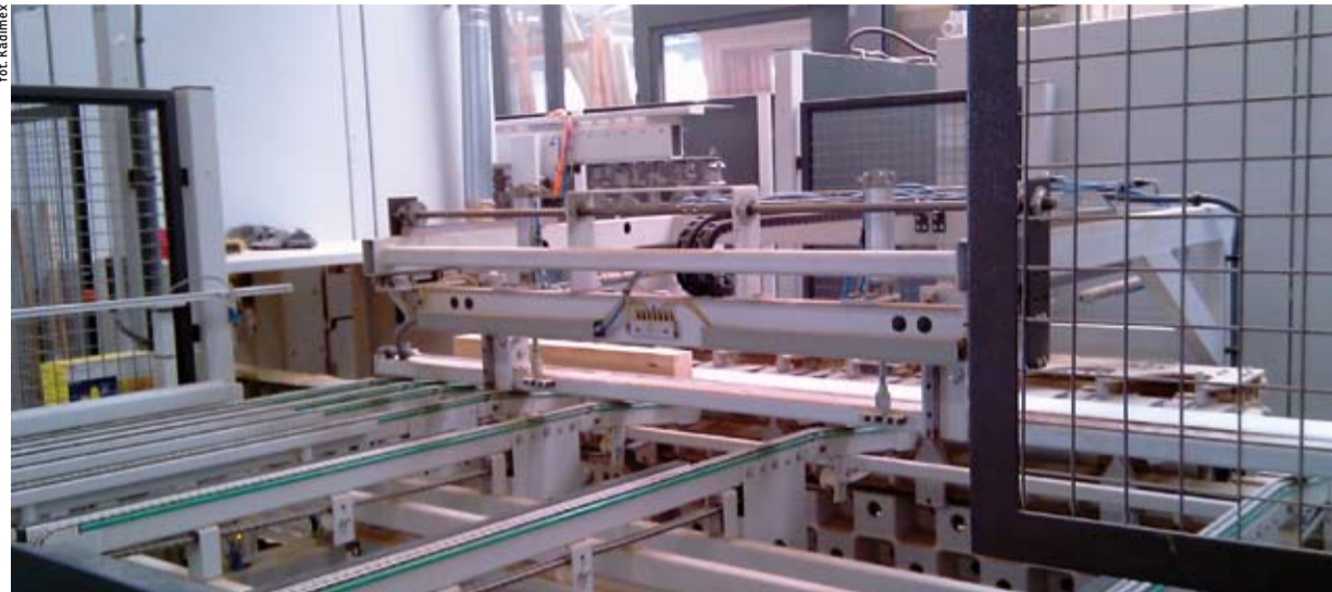
Obróbka na centrum Conturex Compact przebiega zgodnie z parametrami zapisanymi w kodzie kreskowym.
