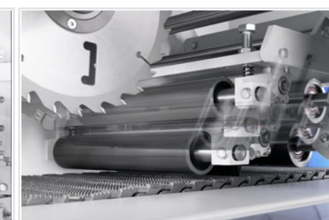
Elektryczna regulacja wysokości docisku: wysoki komfort obsługi
