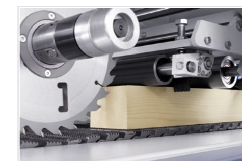
Wysokość cięcia do 110 mm
