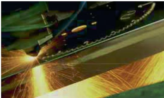
Titman Präzisions-Sägeblätter werden mit Hartmetallzähnen auf Feinkorn-Basis hergestellt. Dies bietet eine der höchsten Standzeiten.
