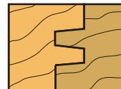
Fräser zur Erzeugung einer Zinkenverbindung. Für Materialstärken von 11 mm bis 26 mm. Umfangschneidend. Rechtslauf.
