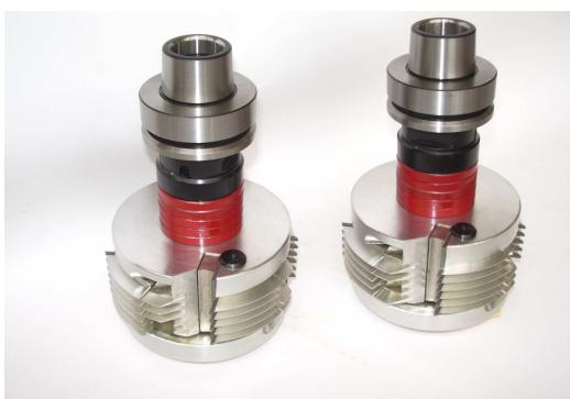
GRUPPI DI FRESE DESTRI (RH) E SINISTRI (LH) REGOLABILI PER GIUNZIONI SPESSESSO LEGNO VARIABILE DA 38 mm A 95 mm CON ANELLI DA 6 mm FORZATURA DELLA GIUNZIONE REGISTRABILE CON VITI
